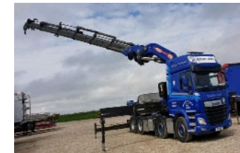
貨車式起重機 (Truck-mounted Crane)
