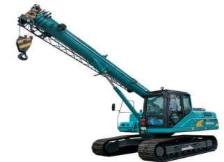
履帶式起重機 (Crawler Crane)
